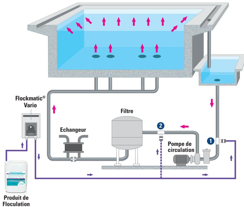
1. Injection avant pompe (recommandé lorsque la contrepression est supérieure à 3 bars)
