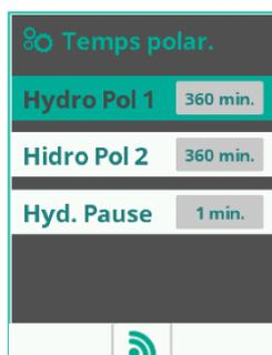
Définit le temps de cycle pendant lequel la cellule de production de chlore fonctionne en polarités 1 et 2 (Hydro Pol1 et Hydro Pol2). Bien qu'un réglage indépendant soit possible, il est recommandé de régler les cycles de la même manière pour les deux polarités.
