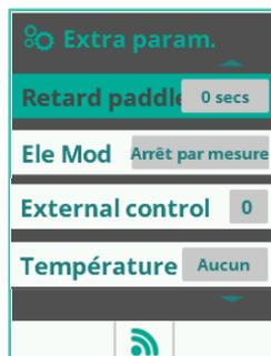
Dans l'option de menu "Retard paddle", un temps de 0 à 60 secondes peut être réglé pour retarder le déclenchement de l'alarme de débit FL1. Cela permet d'éviter les déclenchements intempestifs dus à une réponse courte, liée au système, de l'interrupteur à palette externe ou du capteur de gaz.
